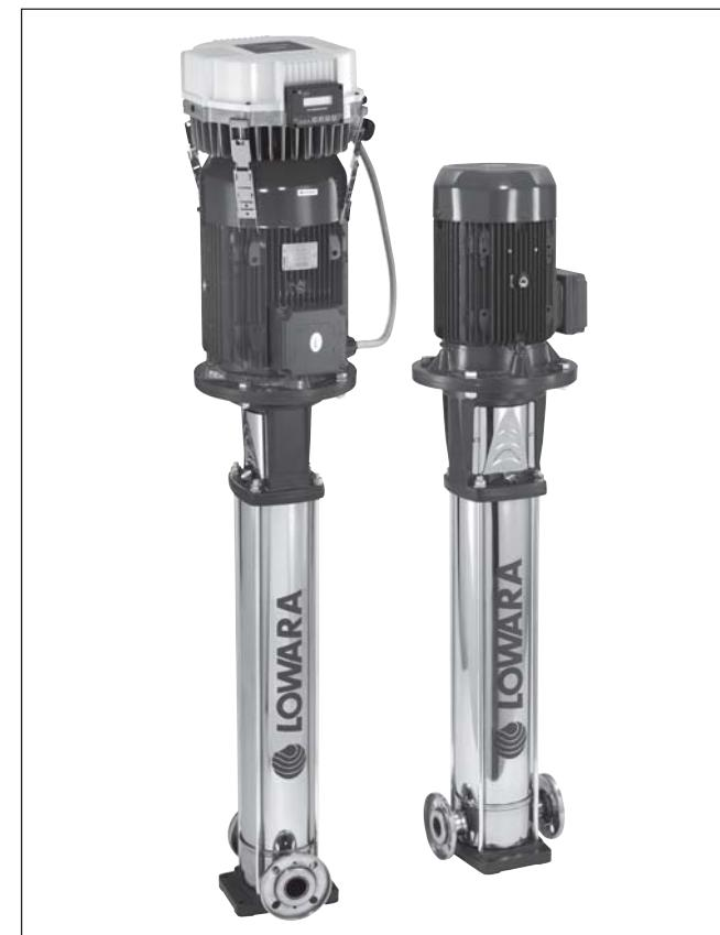
HYDROVAR® sisteminde her bir pompanın hızı sabit basınç veya debiyi korumak için değişir. Sistem basıncının korunması ve sıfır talepte derhal kapanmasının sağlanması için küçük bir tank yeterli olduğundan büyük bir tank kurulmasına gerek yoktur. Yerel yönetmelikler izin verdiği sürece HYDROVAR® sistemleri doğrudan su temini hattına bağlanabilir.
